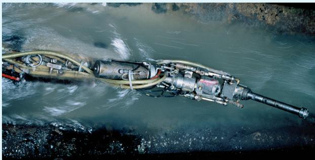
*Mit Hilfe des Satelliten-Roboters können partiell Schäden im Problem-bereich der Anschlussleitungen behoben werden, die nur vom Hauptkanal aus zugänglich sind.*
